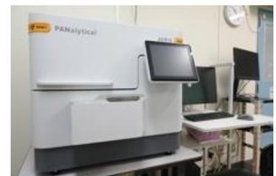
図 4. 卓上型 X 線回折装置
