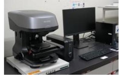
図 1. 3D レーザー顕微鏡
