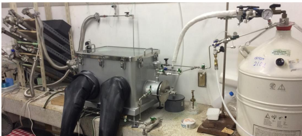
図2. 本研究室で自作したグローブボックス
