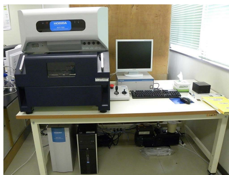
図3 X線分析顕微鏡（XGT） （堀場製作所製） （琉球大学研究基盤センター設置）
