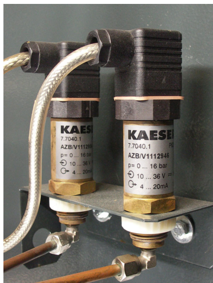
図 2 ドイツ KAESER 社の圧縮機に内蔵の圧力伝送器
